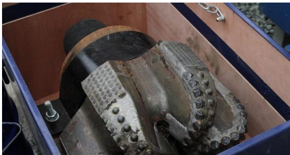
PDC-Meißel ( Polycrystalline Diamond Cutter ), mit Industriediamanten besetzt.
