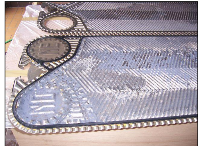
Graue Beläge auf Tauscherplatten (analog 2004)
