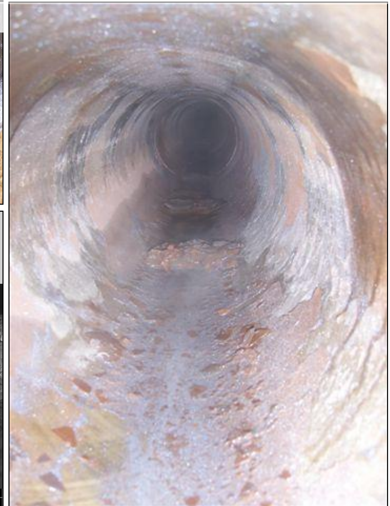
Rohrleitungsschaden bei Bauarbeiten (Thermalwasserleitung zwischen Förderbohrung und Heizwerk) im Juni 2007
