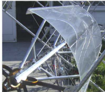
SunRay-Modul mit Fresnel-Linse und PV-Receiver (Labor-Aufbau)
